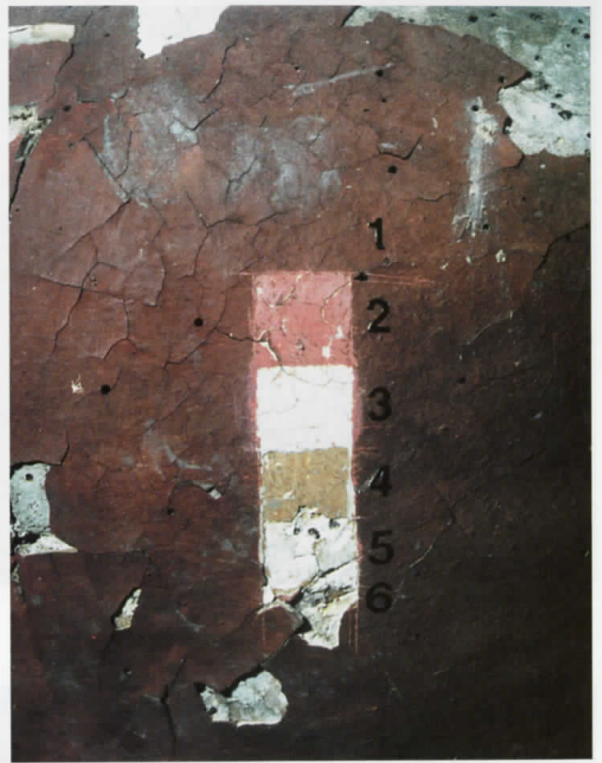
Fragment korony w trakcie badań odkrywkowych. Widoczne 2 opracowania chronologiczne, (bez oryginału) i 5 warstw technologicznych:
